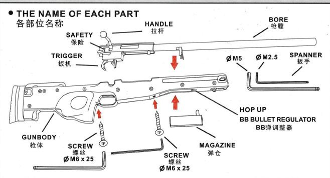
FOLLOW THE DIRECTION OF THE ARROWHEAD TO INSTALL THE GUN, AND SCREW THE BOLT. 跟随箭尖方向安装枪体,并拧紧螺丝。
